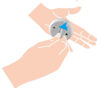
3. Maintenez le bouton du détecteur d'eau enfoncé pendant 5 secondes, puis celui-ci accèdera au mode d'ajout d'appareil.
